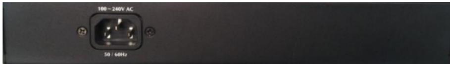
На задней панели коммутатора находится разъем питания 100~240 V AC, 50~60 Hz, max. 2 A.
